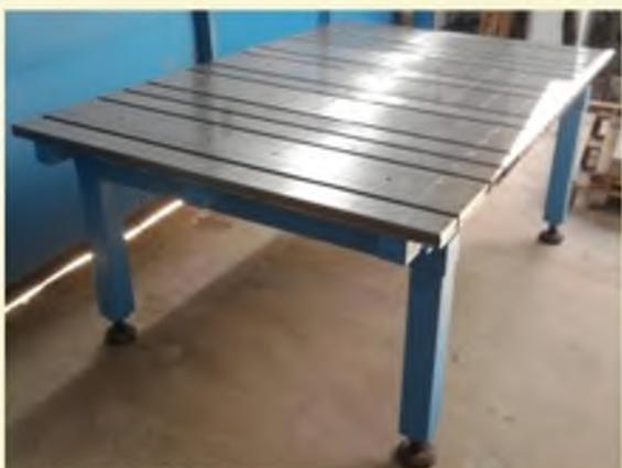
Бруски обработаны на импортном высокоточном оборудовании, двусторонние и полностью взаимозаменяемы, независимо от ширины бруска. При переустановке брусков размерная сетка рабочей поверхности стола не нарушается.
