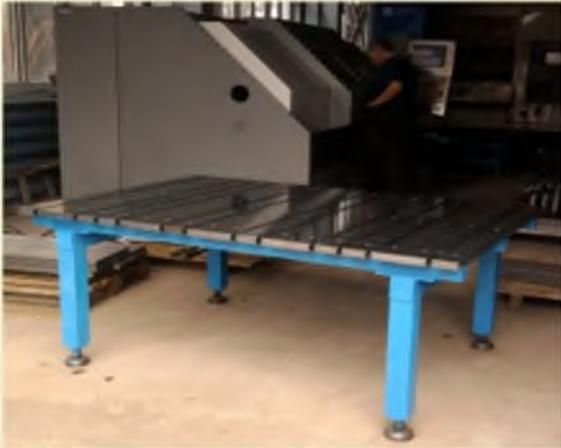
Литые бруски из серого чугуна в конструкции стола применяются двух типов: **типа А** - шириной 85 мм, и **типа В** - шириной 185 мм. При этом ширина Т-образного паза между брусками будет равняться 15 мм. Длина применяемых брусков 1200 мм и 1000 мм.
