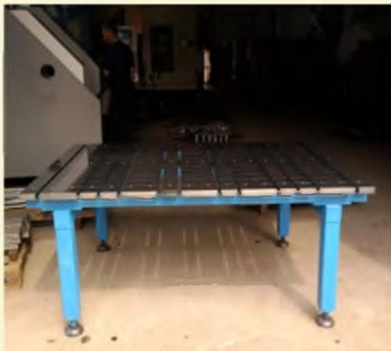
Рабочая поверхность стола состоит из съемных литых чугунных брусков, которые образуют между собой Т-образные пазы для крепления зажимных приспособлений и упоров. Литые бруски изготовлены из серого чугуна модифицированного медью.
